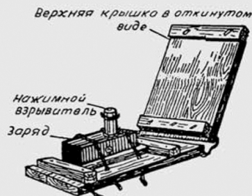
Как расположить заряд на самодельной мине
